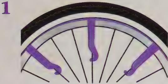
1 Con las palancas, levanta la cubierta de la rueda.
